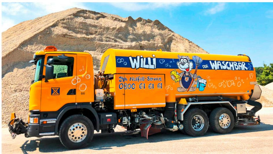
stellen...», ergänzt er weiter. Das heisst, dass zusätzlich zum Rotocleaner am Heck der Maschine, der mit bis zu 300 bar jeden Belag porentief reinigt, über 40 einzelne Waschdüsen mit unterschiedlichsten Reinigungsmodi und 4 Borstenbesen angesteuert werden können. «Willi ist quasi eine Rundumbehandlung Ihrer Zähne bei der Dentalhygienikerin, nur eben für Verkehrsflächen diversester Art...», fügt Markus Ziegler mit einem kleinen, weisen Lächeln hinzu.
